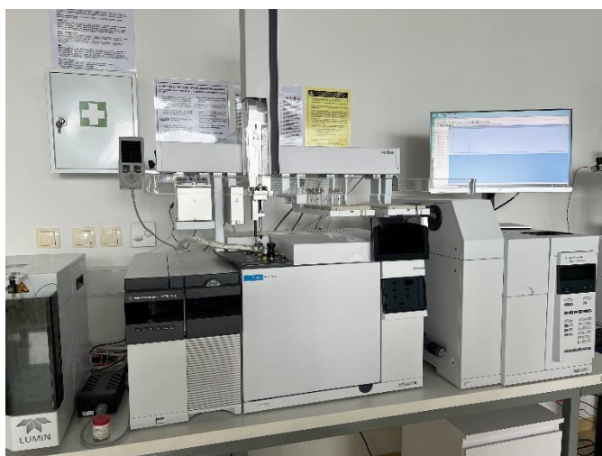
Slika 8. Vezani sustav plinska kromatografija-spektrometrija masa (GC-MS)
