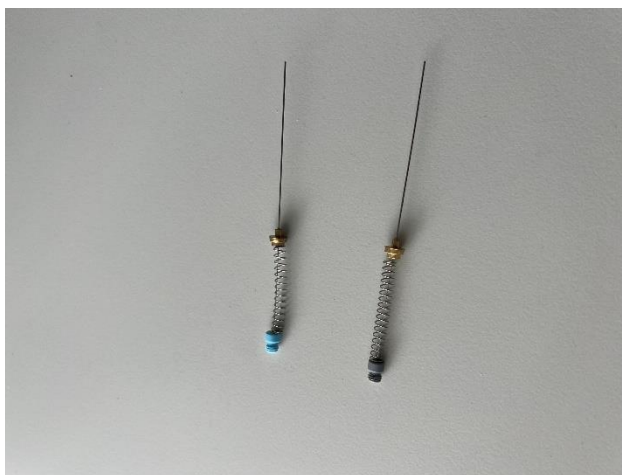
Slika 6. Vlakna s ovojnicama 65 \mu\text{m} PDMS/DVB (svijetlo plavo vlakno) i 50/30 \mu\text{m} DVB/Carboxen/PDMS (sivo vlakno)
