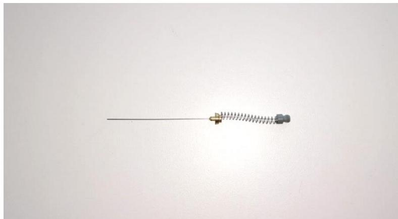
Slika 11. Sivo vlakno divinilbenzen/karboksen/polidimetilsilosan (DVB/CAR/PDMS)
