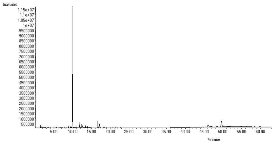
Slika 18. Kromatogram ukupne ionske struje hlapljivih spojeva meda od pajasena (uzorak 2) izoliranih HS-SPME metodom s ovojnicom divinilbenzen/karboksen/polidimetilsiloskan DVB/CAR/PDMS (sivo vlakno)
