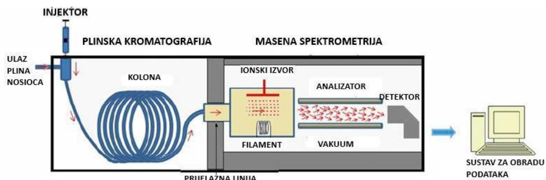
Slika 7. Shematski prikaz vezanog sustava GC-MS (44)
