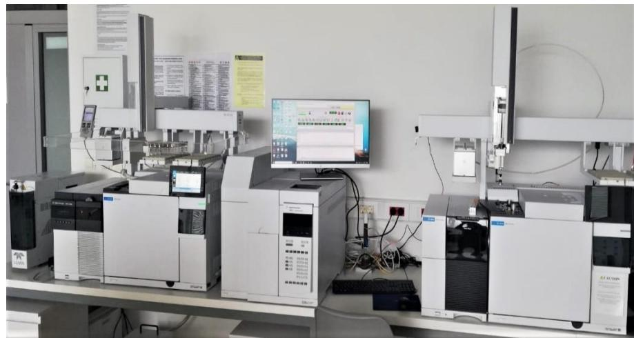
Slika 13. Vezani sustav plinska kromatografija-spektrometrija masa (GC-MS)
