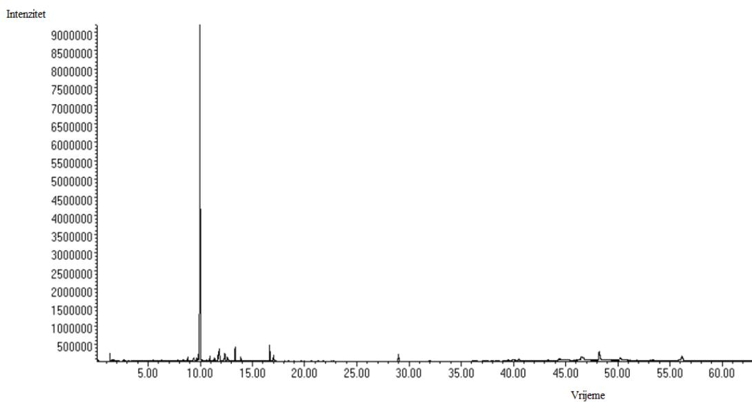
Slika 17. Kromatogram ukupne ionske struje hlapljivih spojeva meda od pajasena (uzorak 2) izoliranih HS-SPME metodom s ovojnicom polidimetilsilosan/divinilbenzen PDMS/DVB (ružičasto vlakno)
