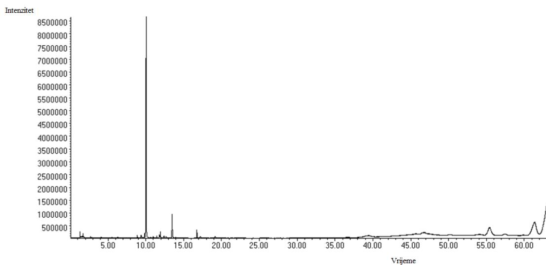
Slika 15. Kromatogram ukupne ionske struje hlapljivih spojeva meda od pajasena (uzorak 1) izoliranih HS-SPME metodom s ovojnicom divinilbenzen/karboksen/polidimetilsilosan DVB/CAR/PDMS (sivo vlakno)
