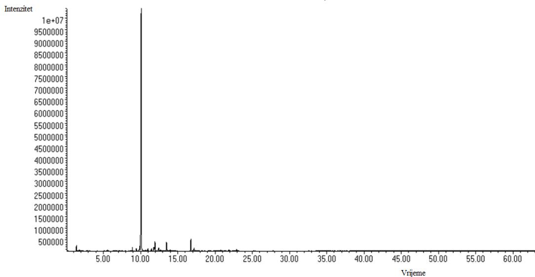
Slika 14. Kromatogram ukupne ionske struje hlapljivih spojeva meda od pajasena (uzorak 1) izoliranih HS-SPME metodom s ovojnicom polidimetilsilosan/divinilbenzen PDMS/DVB (ružičasto vlakno)
