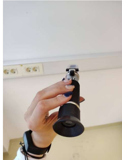
Slika 20. Određivanje šećera/suhe tvari refraktometrom
