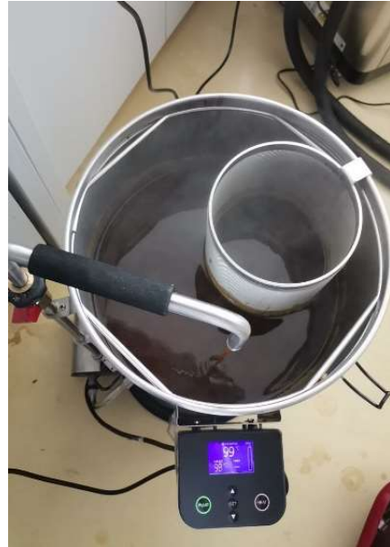
Slika 16. Proces kuhanja sladovine s hmeljom
