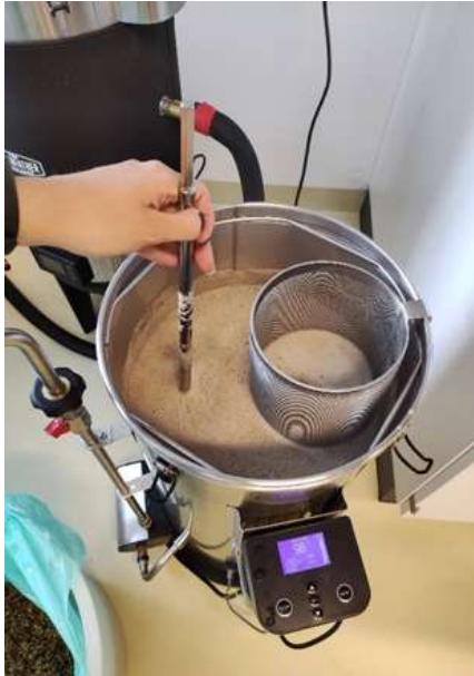
Slika 16. Proces kuhanja sladovine s hmeljom
