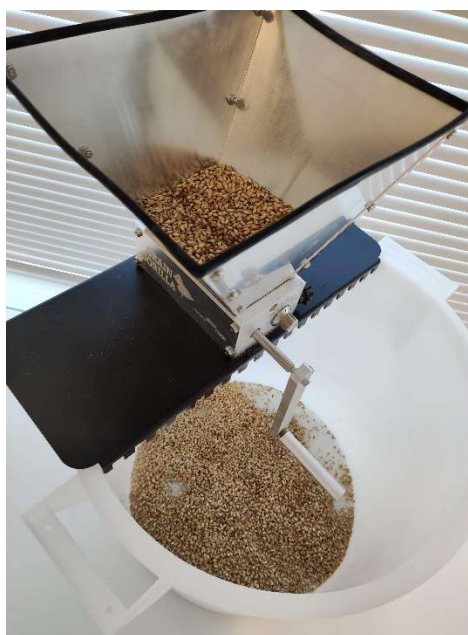
Slika 15. Postupak mljevenja slada pomoću ručnog mlina
