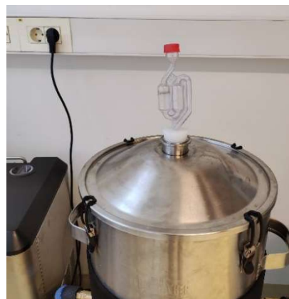
Slika 9. Vrenjača postavljena na poklopac fermentora
