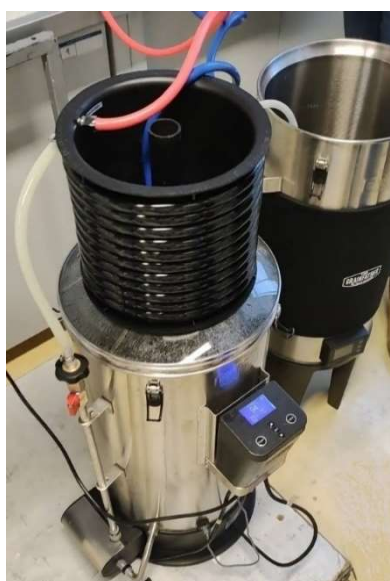
Slika 17. Prikaz hlađenja ohmeljene sladovine uz pomoć spiralnog hladila
