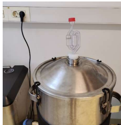
Slika 9. Vrenjača postavljena na poklopac fermentora
