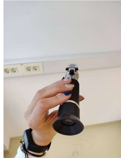
Slika 20. Određivanje šećera/suhe tvari refraktometrom
