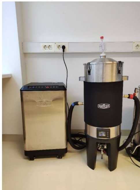
Slika 18. Prikaz Grainfather sustava za kontrolu fermentacije (hladnjak i fermentor)
