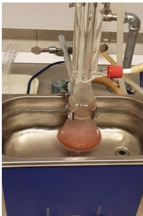
Slika 11. Ultrazvučna ekstrakcija otapalom
