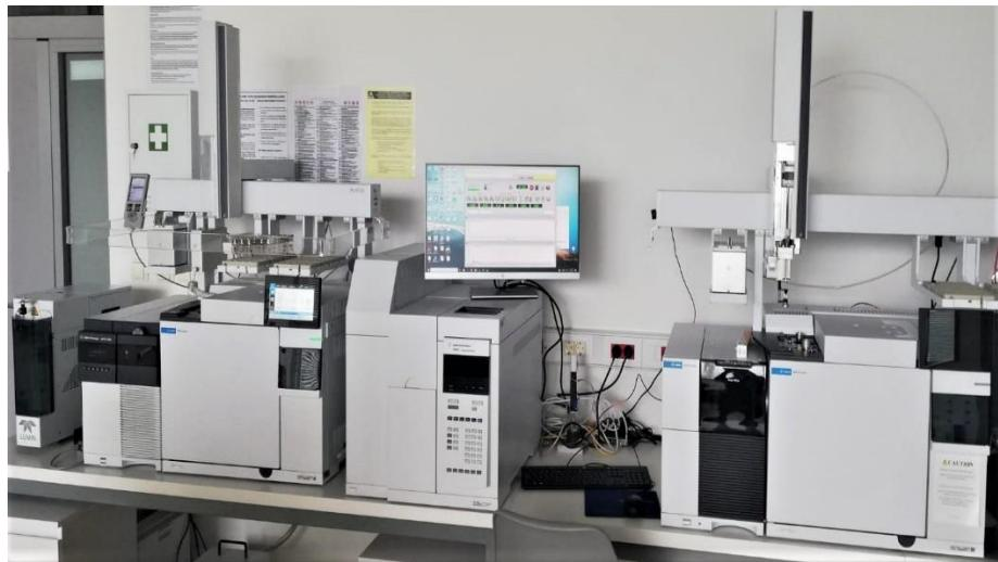
Slika 12. Vezani sustav plinska kromatografija – spektrometrija masa (GC-MS)
