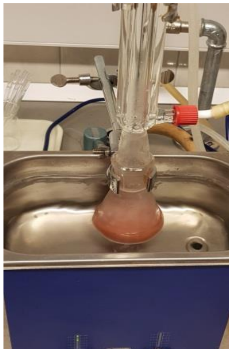
Slika 11. Ultrazvučna ekstrakcija otapalom
