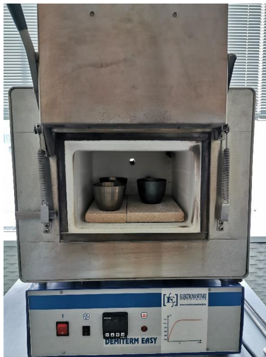
Slika 2.12. Određivanje udjela pepela u pripremljenim uzorcima biougljena
