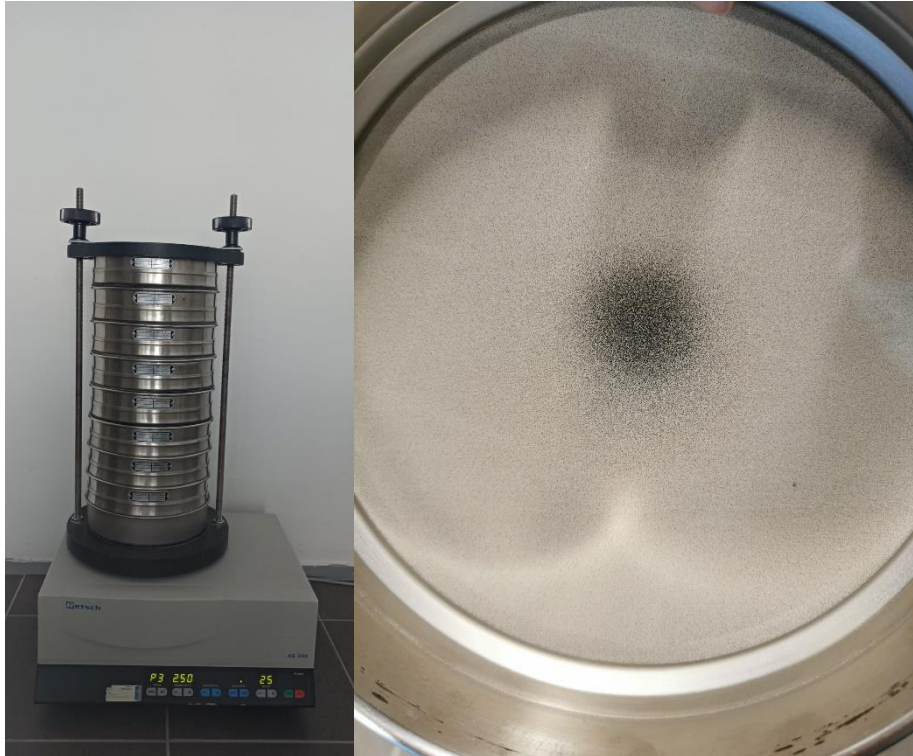
Slika 2.13. Granulometrijska analiza pripremljenih uzoraka biougljena
