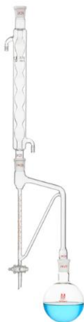
Slika 34. Aparatura po Clevengeru (71)
