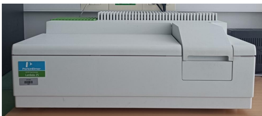
Slika 14. UV/Vis spektrofotometar PERKIN ELMER LAMBDA 25
