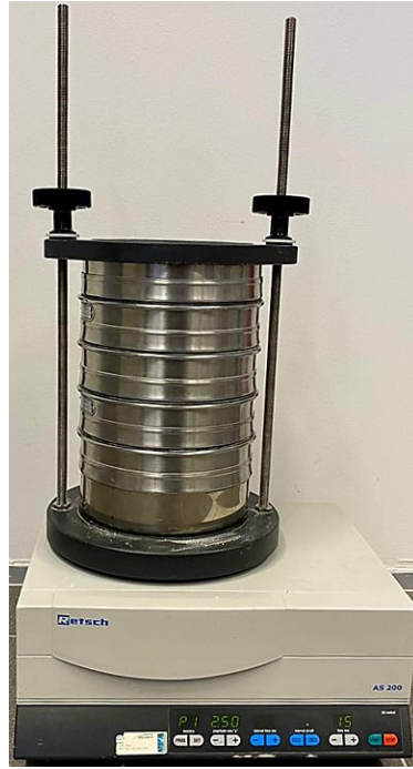
Slika 8. Tresilica tipa Retsch AS 200 .
