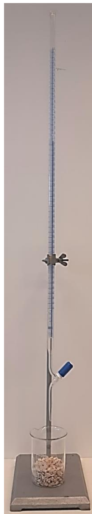
Slika 11. Aparatura za određivanje poroznosti sloja.
