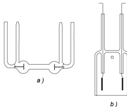
**Slika 1.** Tipovi konduktometrijskih čelija<sup>2</sup>
