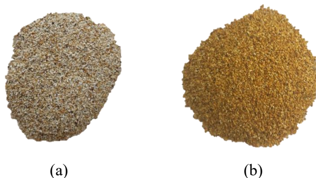
Slika 2.1. Usporedba (a) prirodnog i (b) Fe(III)-modificiranog zeolita.
