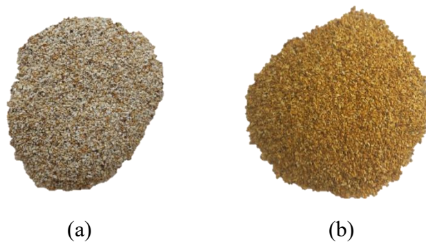
Slika 2.1. Usporedba (a) prirodnog i (b) Fe(III)-modificiranog zeolita.
