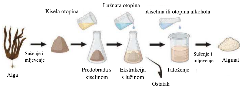
Slika 6. Klasični postupak ekstrakcije alginata iz smeđih algi 16
