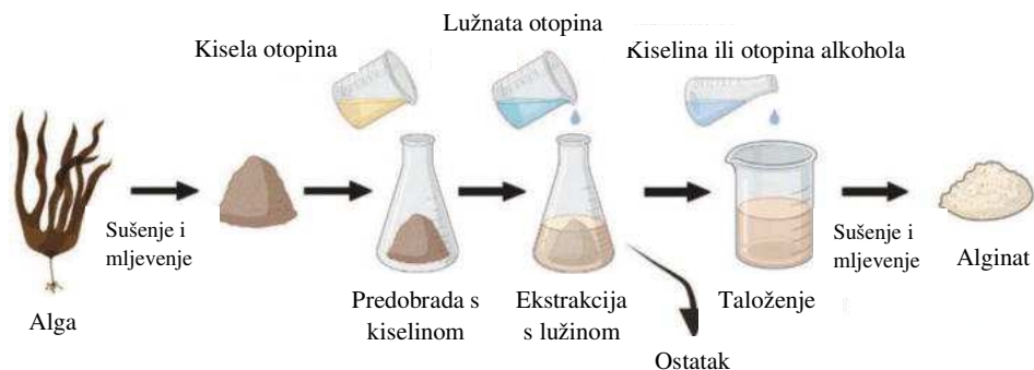
Slika 6. Klasični postupak ekstrakcije alginata iz smeđih algi 16
