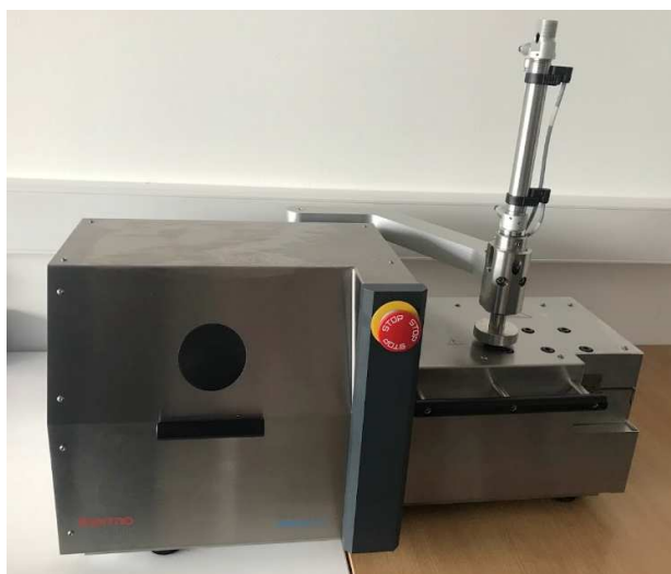
Slika 10. Dvopužni laboratorijski ekstruder HAAKE MiniLab 3
