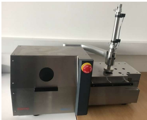
Slika 11. Dvopužni laboratorijski ekstruder HAAKE MiniLab 3
