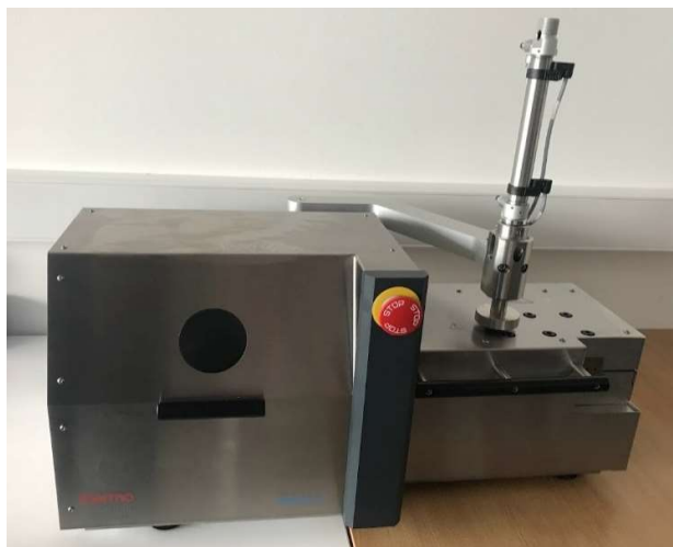
Slika 11. Dvopužni laboratorijski ekstruder HAAKE MiniLab 3
