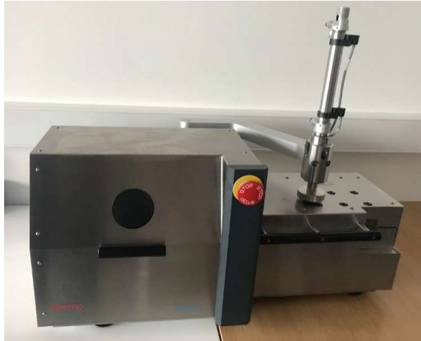
Slika 11. Dvopužni laboratorijski ekstruder HAAKE MiniLab 3
