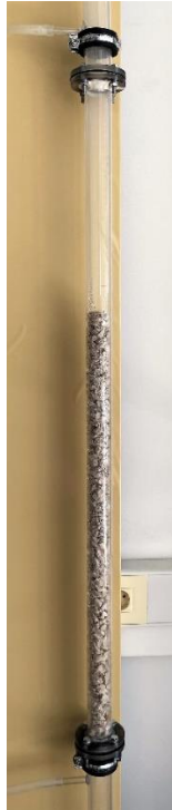
Slika 9. Kolona s poroznim slojem čestica.
