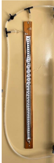
Slika 14. U-manometar za mjerenje pada tlaka kroz porozni sloj.
