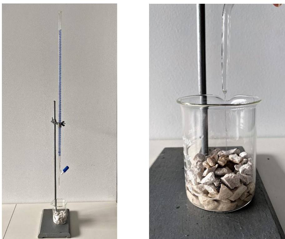
Slika 16. Aparatura za određivanje poroznosti metodom zasićenja.
