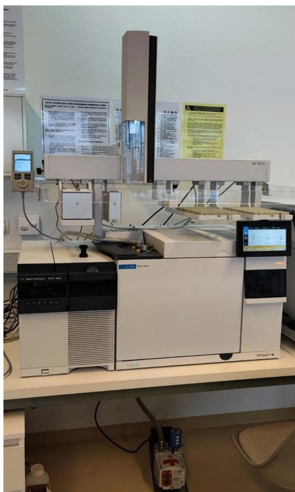
**Slika 6.** Korišteni vezani sustav plinska kromatografija-spektrometrija masa (GC-MS).
