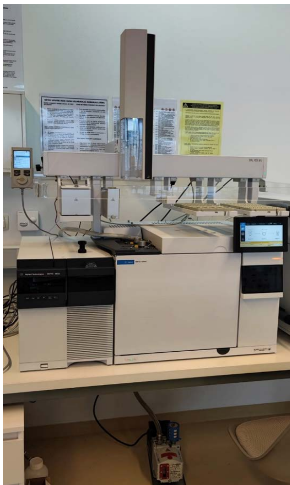
Slika 6. Korišteni vezani sustav plinska kromatografija-spektrometrija masa (GC-MS).
