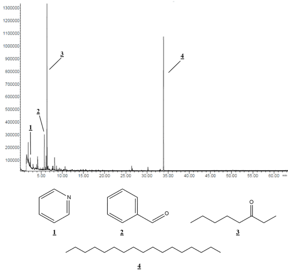
Slika 7. Kromatogram ukupne ionske struje isparljivih spojeva HS-SvPFR s naznačenim kvantitativno važnim spojevima: 1. piridin; 2. benzaldehid; 3. oktan-3-on; 4. heptadekan.
