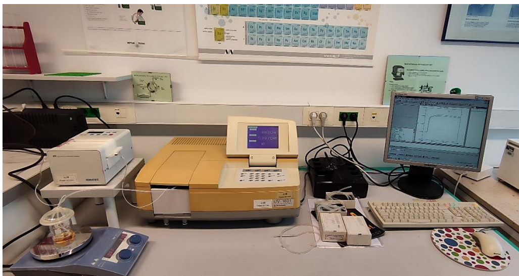
Slika 14. Sustav za spektrofotometrijsko praćenje kemijske reakcije
