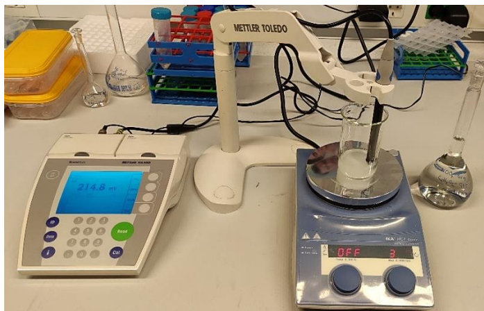
Slika 15. Milivoltmetar Mettler Toledo SevenMulti sa kombiniranom staklenom elektrodom
