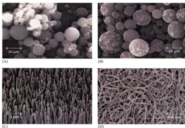
**Slika 7.** Mikrostruktura novih ugljikovih i grafitnih materijala. (A) Staklasti ugljikov prah s neobrađenom površinom; (B) s obrađenom površinom; (C) ugljikova nanovlakna; (D) jednozidne ugljikove nanocijevi<sup>8</sup>
