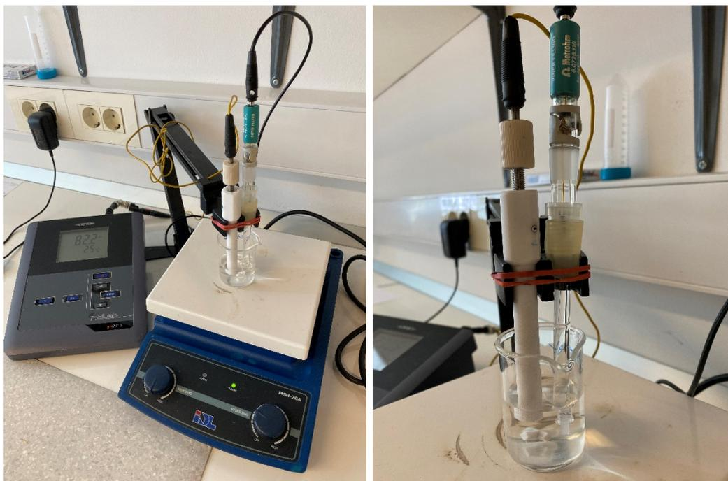
**Slika 21.** *Mjerenje potencijala*
