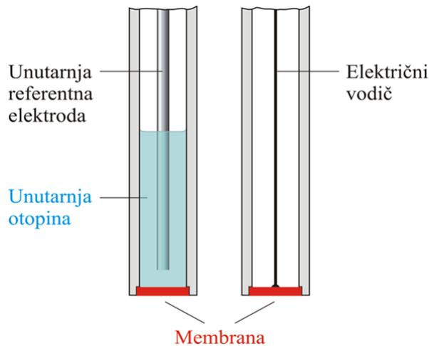
Slika 2. Ion-selektivna elektroda <sup>10</sup>
