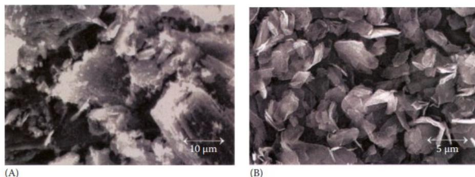
**Slika 5.** Mikrostruktura 2 tipična spektroskopska grafitna praha <sup>8</sup>
