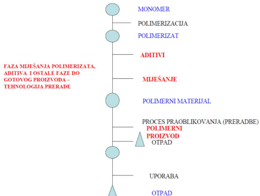
*Slika 5.* Faze tehnološkog procesa proizvodnje polimernih proizvoda<sup>19</sup>
