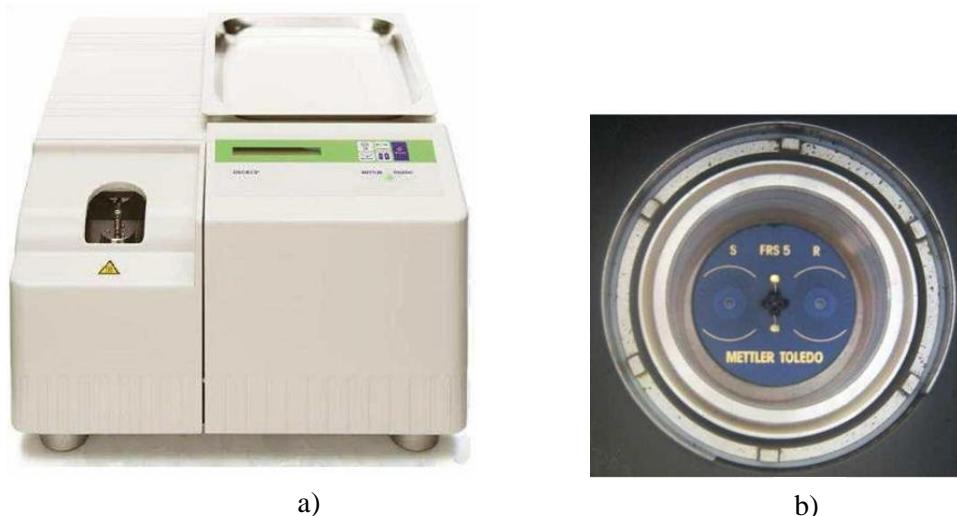
**Slika 17.** a) Diferencijalni pretražni kalorimetar DSC 823e (Mettler Toledo, Švicarska) i b) mjerno osjetilo<sup>45</sup>
