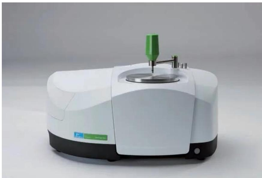
Slika 19. FT-IR spektrometar Spectrum Two (Perkin–Elmer) s dodatkom za snimanje HATR tehnikom<sup>46</sup>
