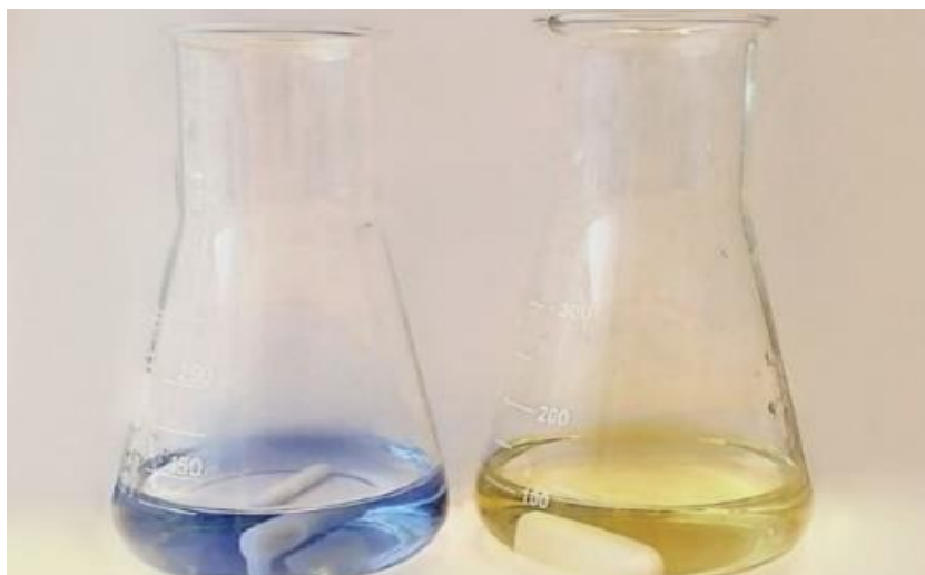
Slika 2.2. Prijelaz boje u točki ekvivalencije pri kompleksometrijskoj titraciji olova.
