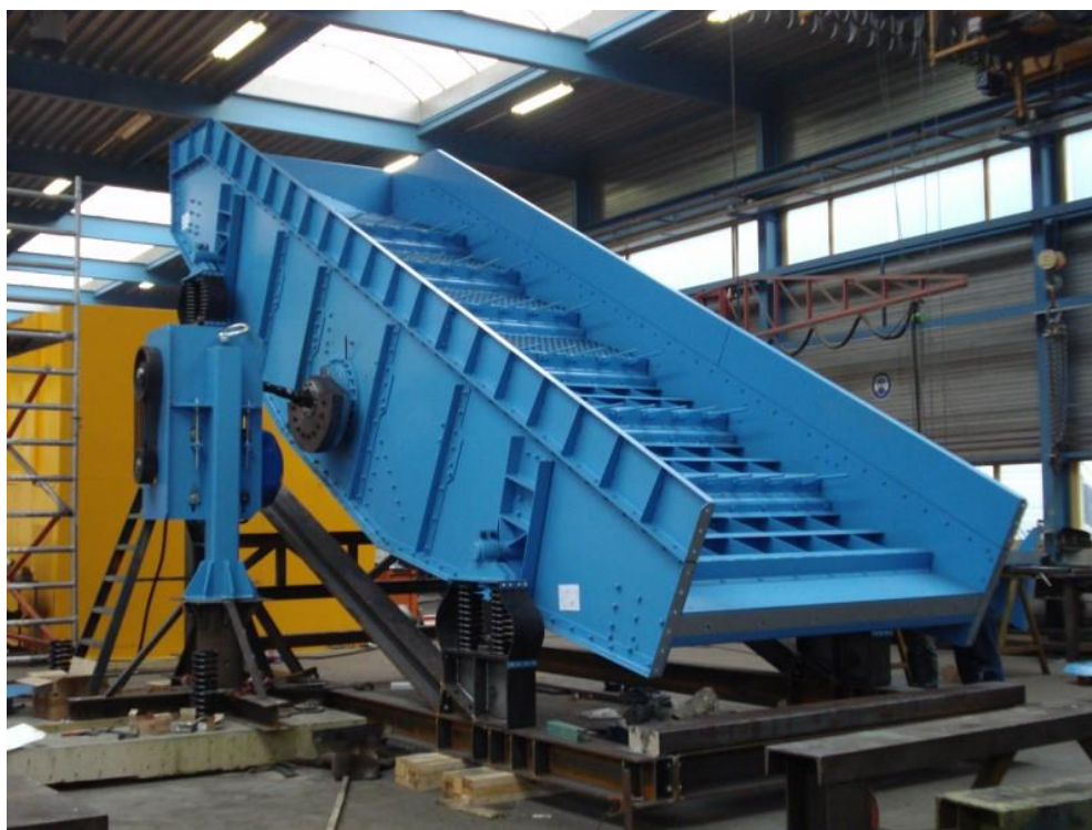
Slika 16. Linearno vibracijsko sito 29
