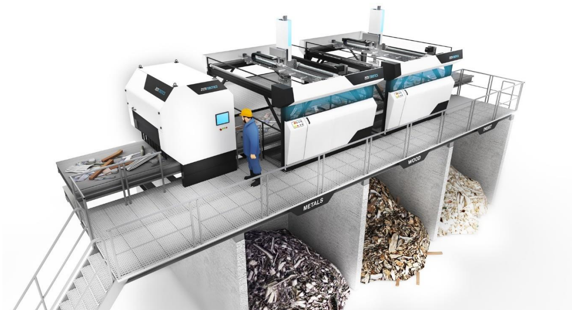
Slika 21. ZenRobotics postrojenje za sortiranje otpada 37
