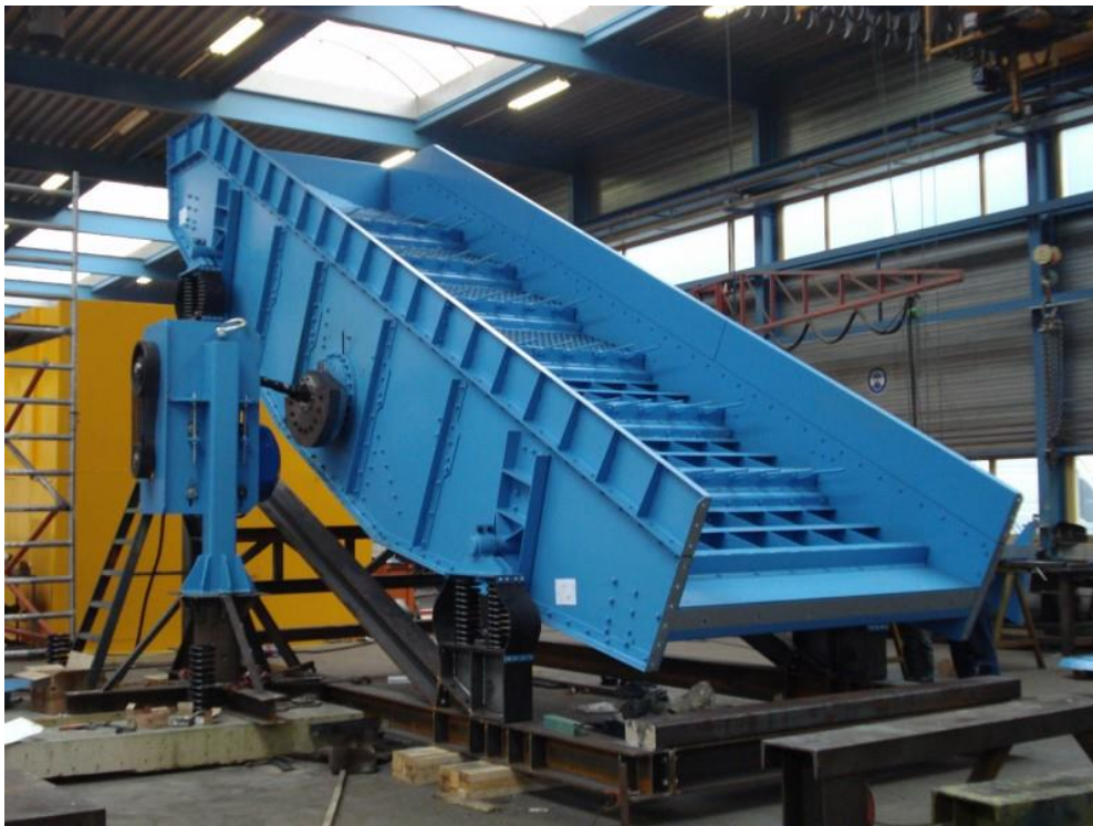
Slika 16. Linearno vibracijsko sito 29
