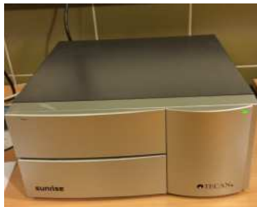
Slika 23. Čitač mikrotitarskih pločica i računalo za obradu rezultata
