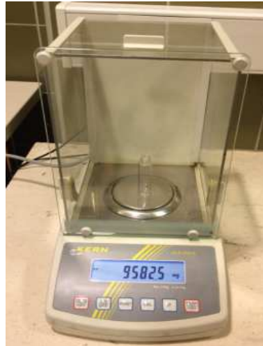
Slika 16. Analitička vaga korištena u pripremi otopina
