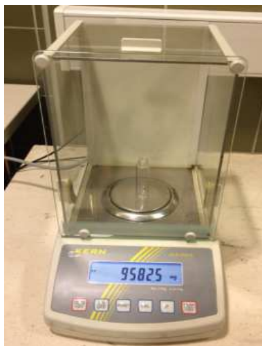
Slika 16. Analitička vaga korištena u pripremi otopina
