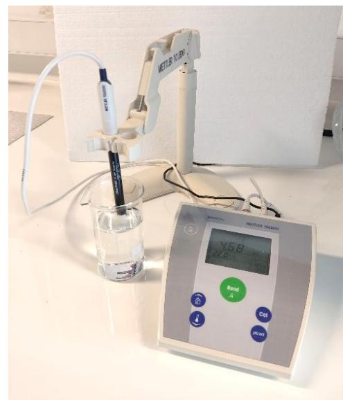
Slika 2.6. pH-metar *Mettler Toledo*
