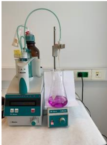
Slika 2.4. Promjena boje prilikom određivanja cinka kompleksometrijskom titracijom
