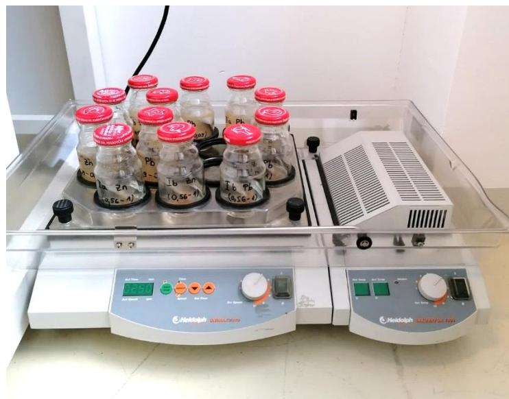
Slika 2.7. Laboratorijska tresilica *Heidolph Unimax 1010* s uzorcima
