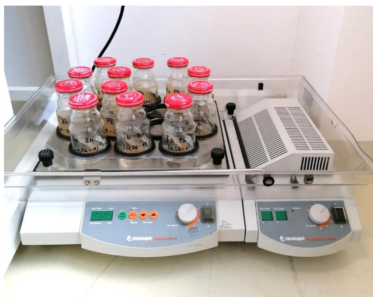
Slika 2.7. Laboratorijska tresilica Heidolph Unimax 1010 s uzorcima
