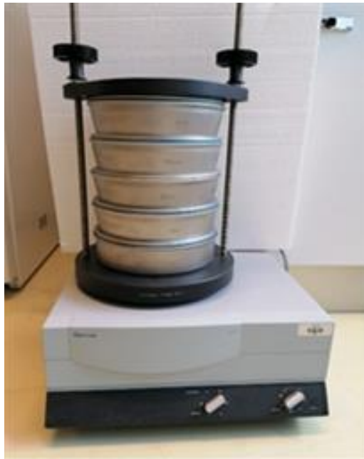
Slika 2.1. Laboratorijski uređaj za prosijavanje Retsch AS200 basic '
