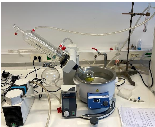
Slika 16. Uklanjanje etanola rotacionim vakuum uparivačem
