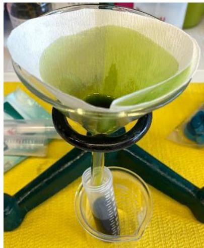
**Slika 14.** Filtracija uzorka nakon centrifugiranja
