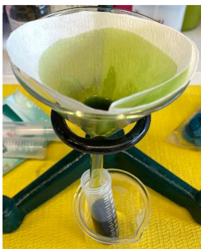
Slika 14. Filtracija uzorka nakon centrifugiranja
