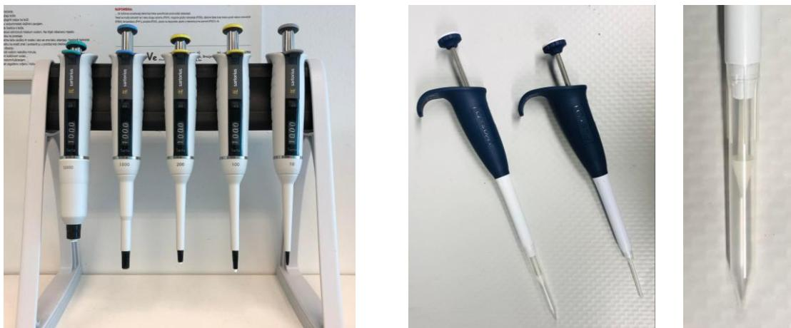
**Slika 2.3.** Mehaničke pipete Tacta (Sartorius, Njemačka) i pipete na principu pozitivno istisnutog volumena Pos-D (Mettler Toledo, SAD)
