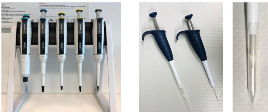
Slika 2.3. Mehaničke pipete Tacta (Sartorius, Njemačka) i pipete na principu pozitivno istisnutog volumena Pos-D (Mettler Toledo, SAD)
