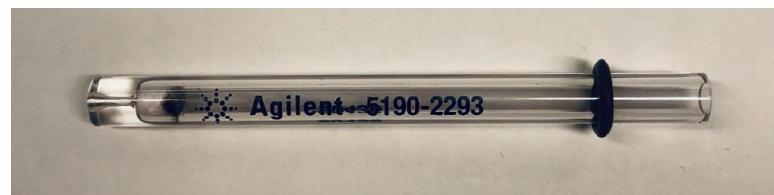
**Slika 1.5.** Stakleni umetak – *liner*
