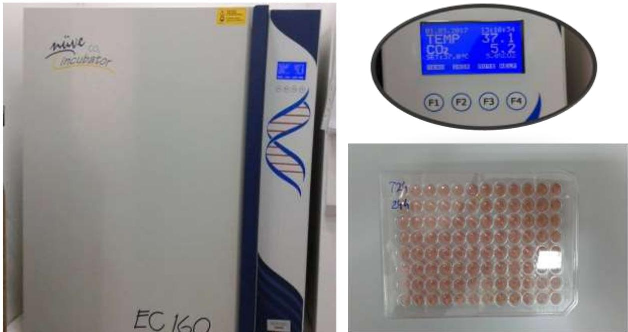
**Slika 9.** Vlažni inkubator i ploča s 96 jažica
