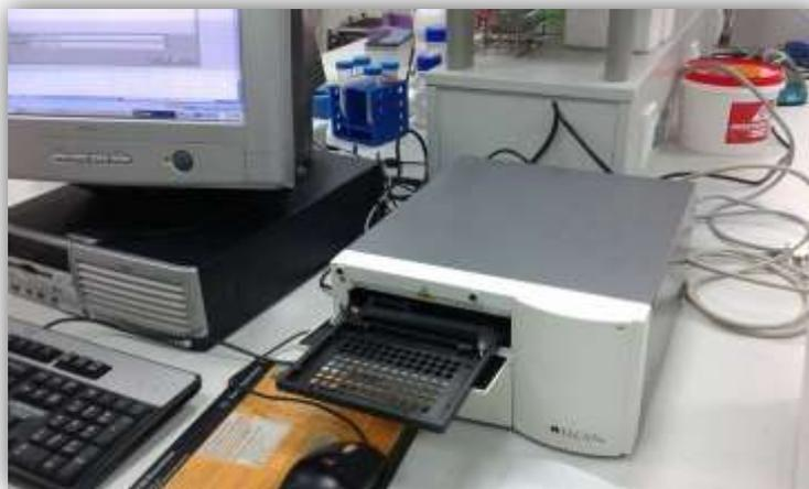
**Slika 11.** Spektrofotometar
