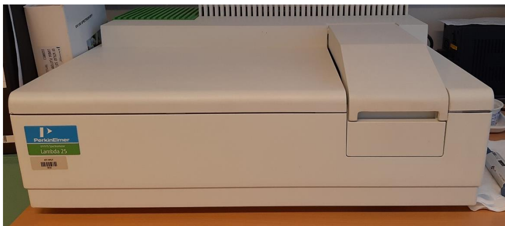
Slika 17. UV/VIS spektrofotometar Perkin Elmer Lambda 25
