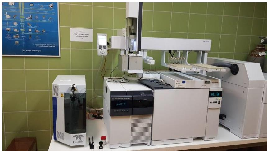
**Slika 9.** Vezani sustav plinska kromatografija-spektrometrija masa (GC-MS)
