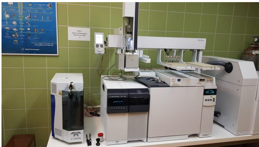
Slika 9. Vezani sustav plinska kromatografija-spektrometrija masa (GC-MS)
