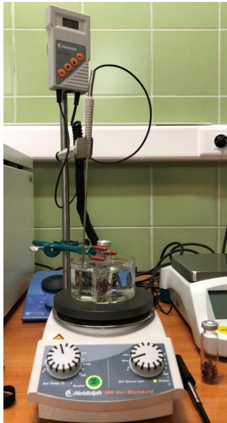
**Slika 8.** Aparatura za mikroekstrakciju vršnih para na čvrstoj fazi (HS-SPME)
