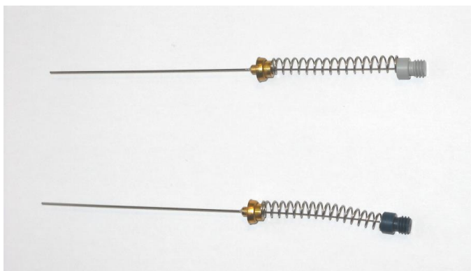
Slika 7. Vlakna s ovojnicama PDMS/DVB (plavo vlakno) i DVB/CAR/PDMS (sivo vlakno)
