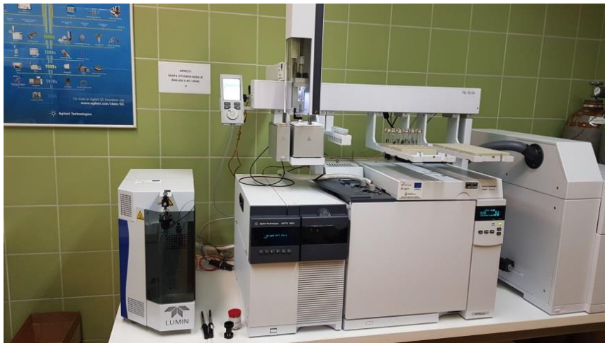
Slika 9. Vezani sustav plinska kromatografija-spektrometrija masa (GC-MS)
