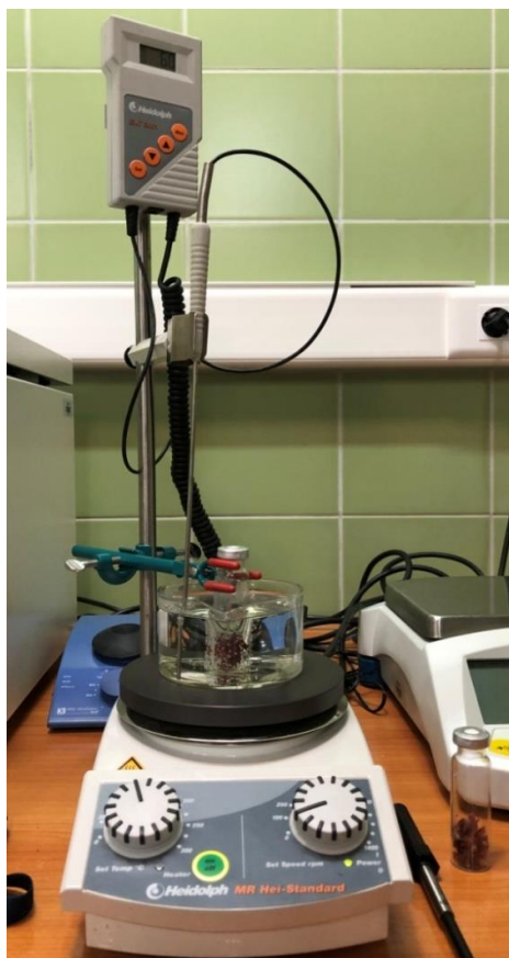
Slika 8. Aparatura za mikroekstrakciju vršnih para na čvrstoj fazi (HS-SPME)
