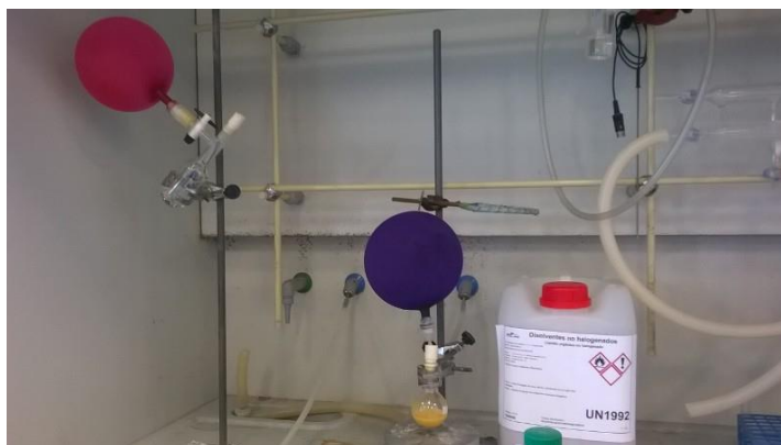
Slika 11. Miješanje uzorka magnetskom miješalicom u inertnoj atmosferi
