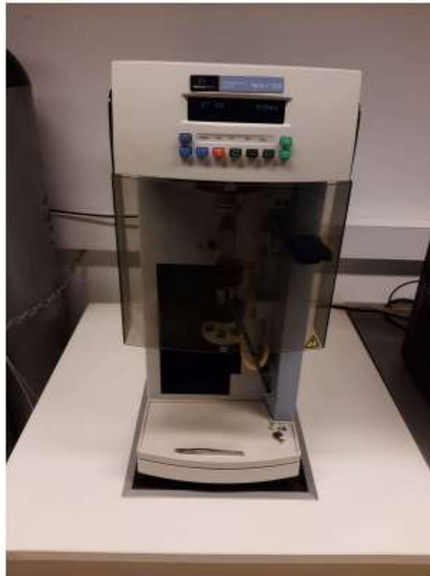
Slika 7. Termogravimetar Perkin-Elmer Pyris 1 TGA
