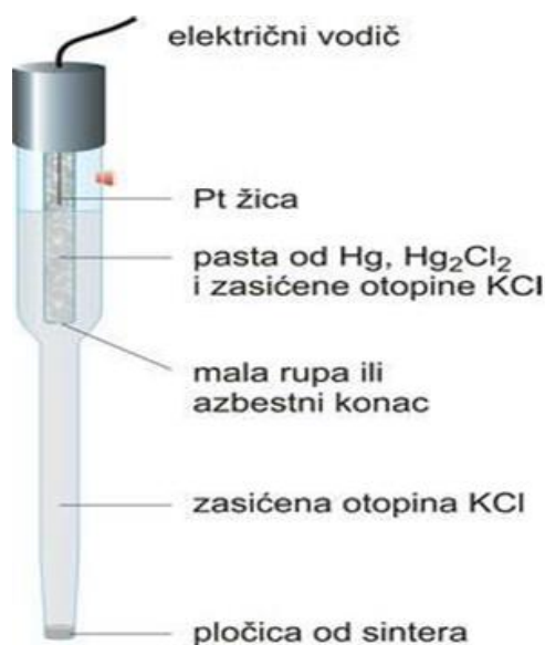
Slika 4. Kalomel elektroda 12
