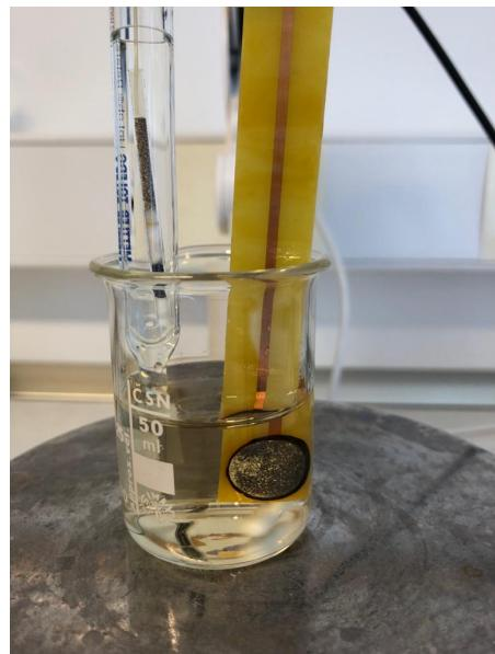
Slika 18. Prikaz referentne i ion-selektivne elektrode u rjeđaju analita
