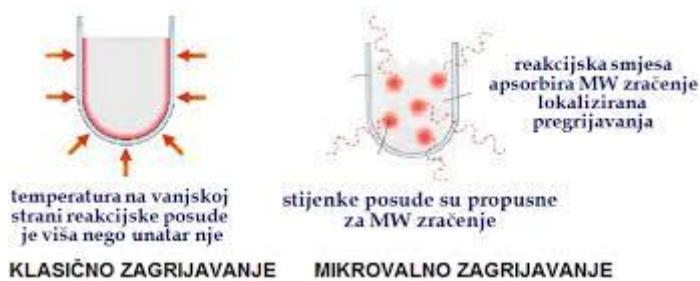
Slika 15. Usporedba klasičnog i mikrovalnog zagrijavanja<sup>25</sup>
