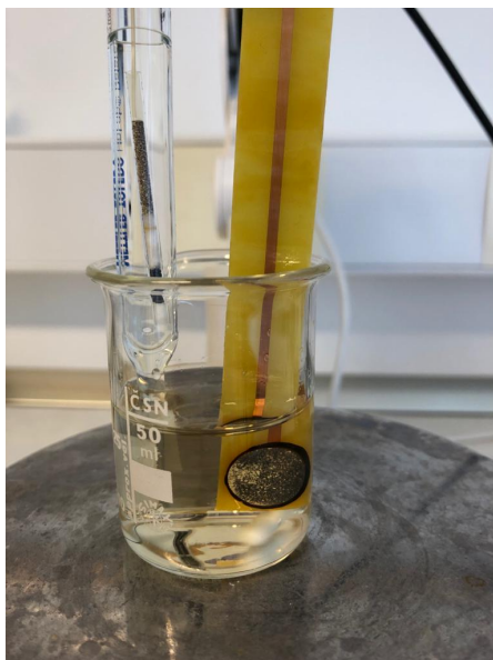
Slika 18. Prikaz referentne i ion-selektivne elektrode u otopini analita
