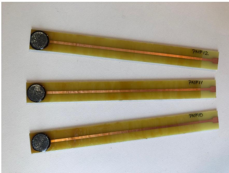
Slika 17. Prikaz ionsko selektivnih elektroda laboratorijske izrade
