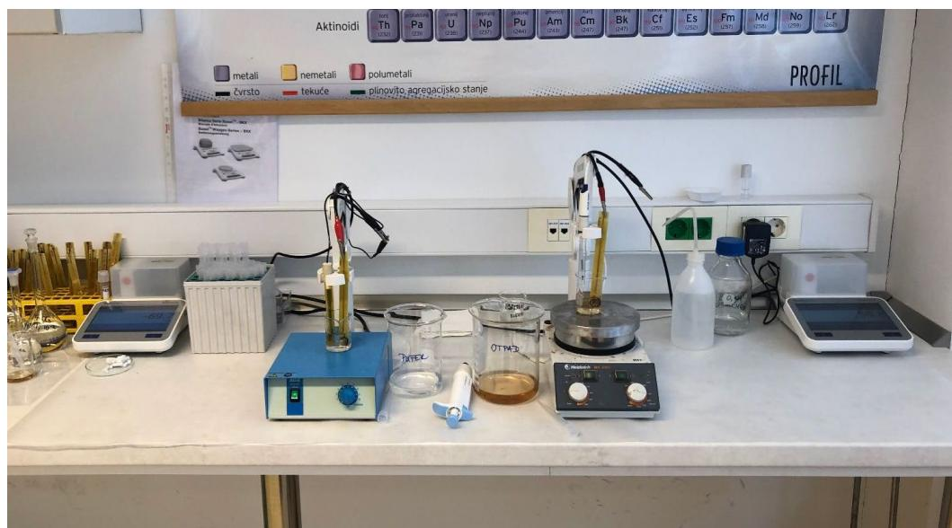
Slika 21. Potenciometrijsko mjerenje
