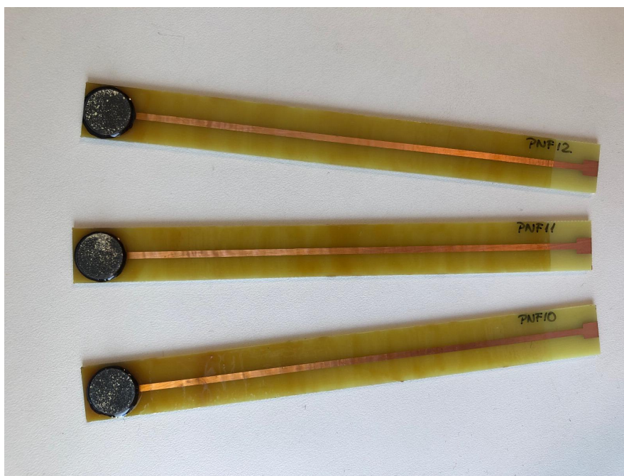
Slika 17. Prikaz ionsko selektivnih elektroda laboratorijske izrade
