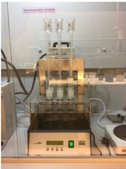
Slika 2.5 Kuhanje smjese u digestoru
