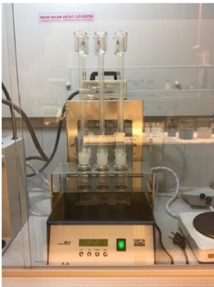
Slika 2.5 Kuhanje smjese u digestoru
