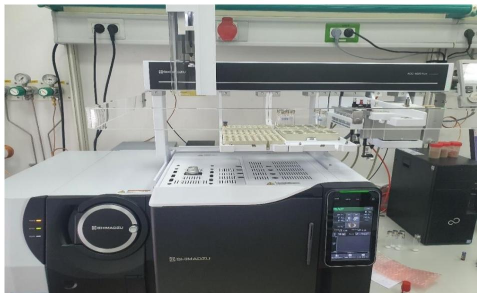
**Slika 14.** Vezani sustav plinska kromatografija-masena spektrometrija (GC-MS)
