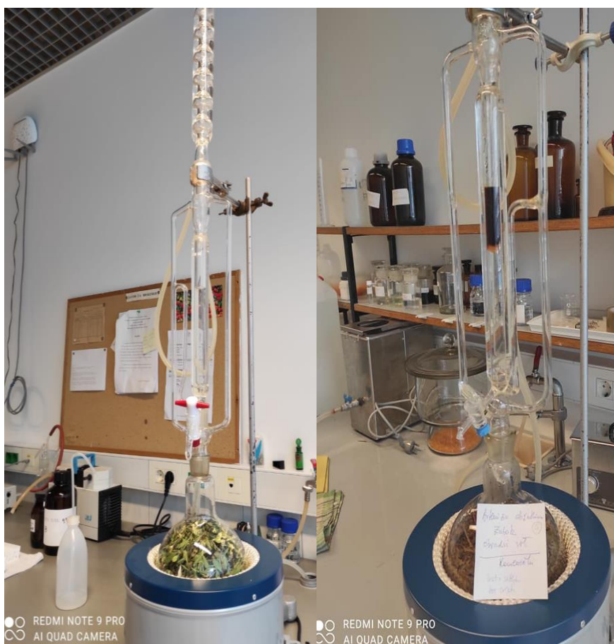
Slika 24. Izolacija eteričnog ulja vodenom destilacijom u aparaturi po Clevengeru
