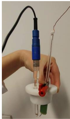
Slika 20. Referentna elektroda (lijevo) i protuelektroda (desno)
