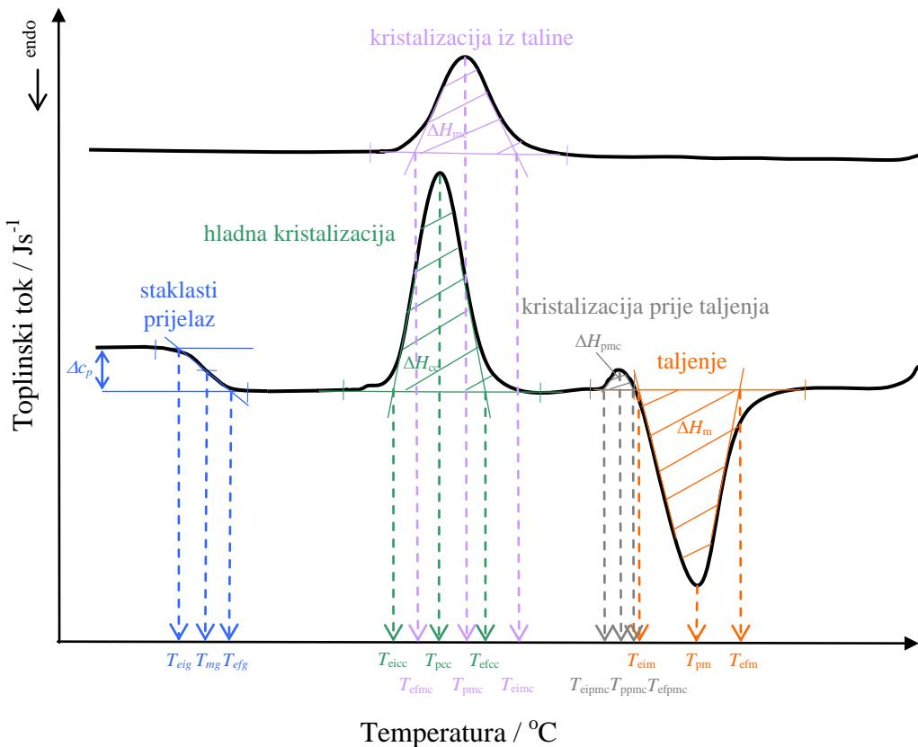
**Slika 12.** Određivanje značajki krivulje diferencijalne pretražne kalorimetrije<sup>32</sup>
