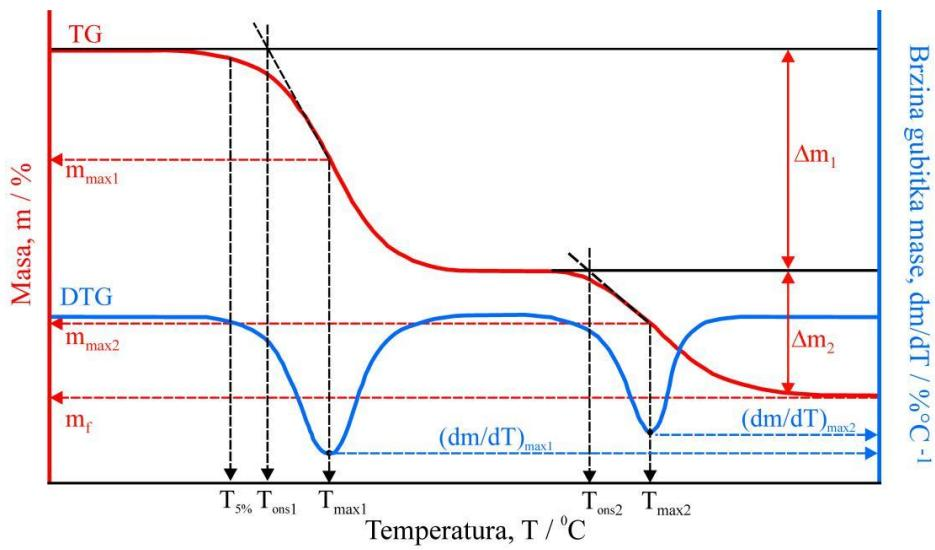
**Slika 13.** Određivanje značajki termogravimetrijskih krivulja<sup>32</sup>
