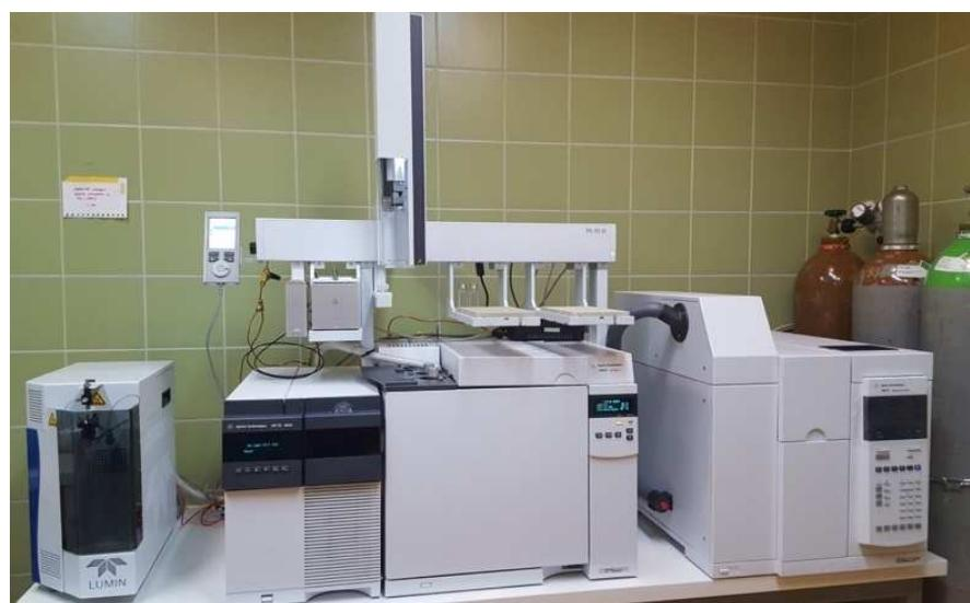
**Slika 11.** Spregnuta tehnika plinska kromatografija-spektrometrija masa (GC-MS)
