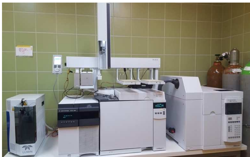
Slika 11. Spregnuta tehnika plinska kromatografija-spektrometrija masa (GC-MS)
