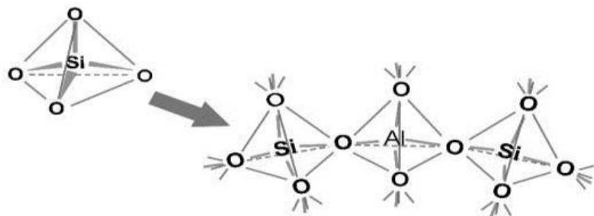
**Slika 3.** Shematski prikaz vezivanja primarnih strukturalnih jedinica<sup>8</sup>
