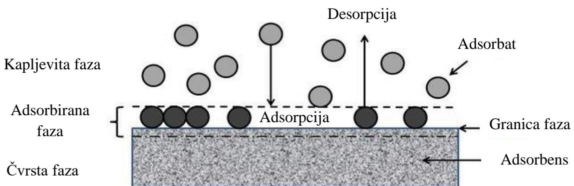
**Slika 6.** Shematski prikaz adsorpcije<sup>13</sup>
