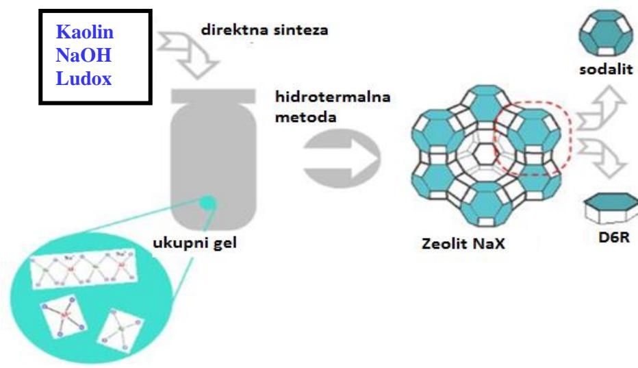
**Slika 12.** Sinteza Zeolita NaX iz kaolina<sup>31</sup>
