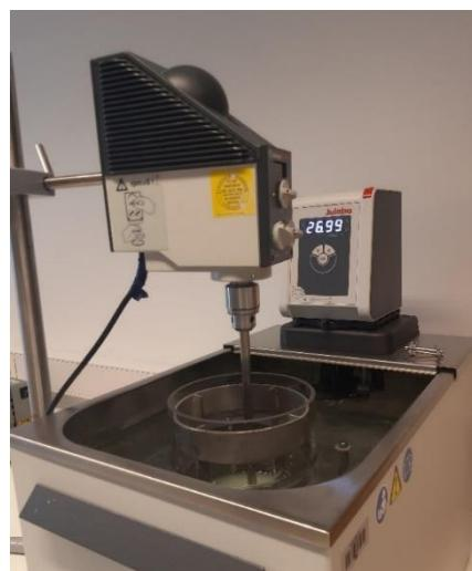
**Slika 19.** Kotlasti reaktor uronjen u termostatiranu kupelj
