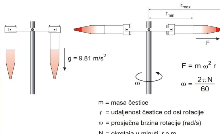
**Slika 23.** Princip centrifugiranja<sup>53</sup>
