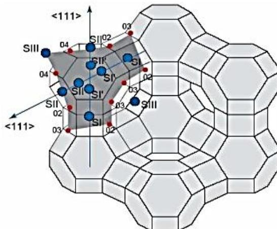
**Slika 8.** Struktura i moguća mjesta izmjene kationa u zeolitu FAU<sup>17</sup>
