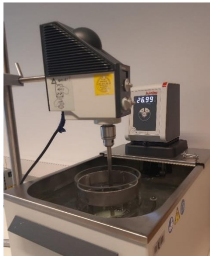
Slika 19. Kotlasti reaktor uronjen u termostatiranu kupelj
