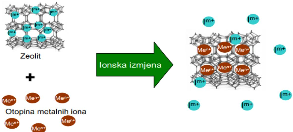
**Slika 7.** Shematski prikaz ionske izmjene<sup>11</sup>
