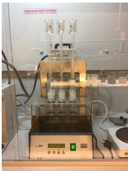
Slika 2.6. Kuhanje smjese u digestoru uz povrat
