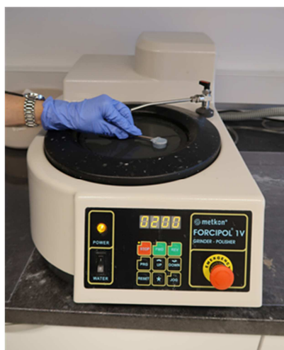
Slika 2.3. Priprema radne površine Ti i Ti-6V-4Al legure na uređaju Metkon Forcipol 1V
