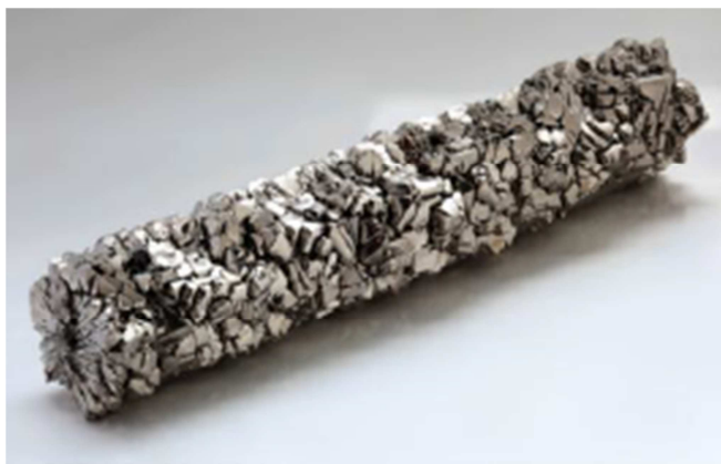
Slika 1.2. Titanij dobiven van Arkel-de Boer postupkom 18
