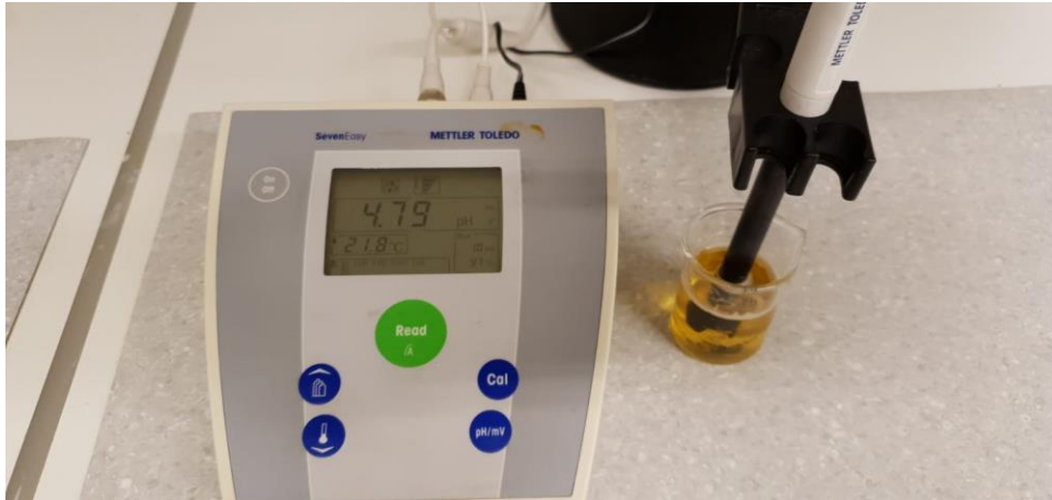
Slika 2.2. Uređaj za određivanje pH vrijednosti
