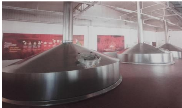
Slika 1.9. Kotlovi za kuhanje sladovine u tvornici „Heineken Hrvatska“ 21
