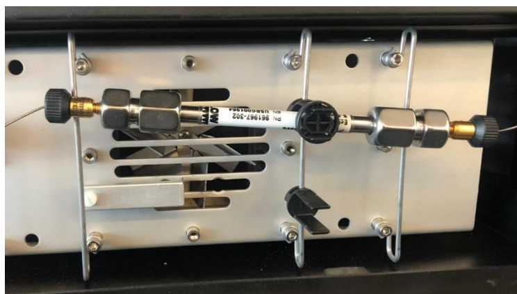
Slika 30. Stacionarna faza (Hypersil GOLD C-18 kolona)
