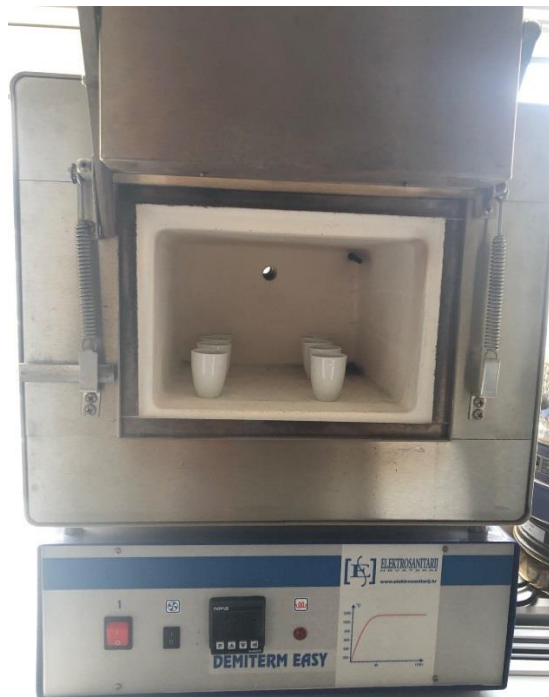
Slika 26. Uzorci na žarenju u peći
