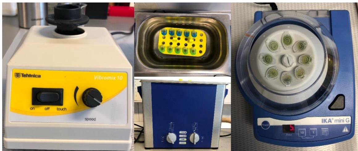
**Slika 23.** Vorteks, ultrazvučna kupelj i centrifuga
