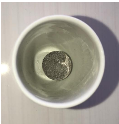
Slika 27. Izgled uzorka nakon žarenja
