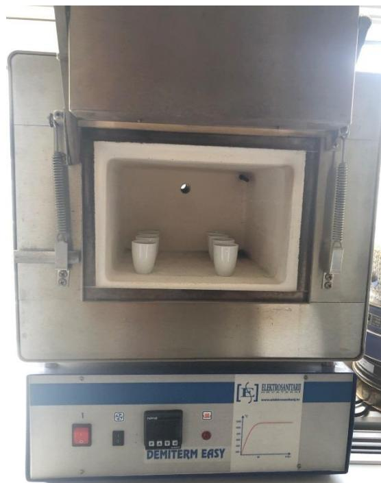
**Slika 26.** Uzorci na žarenju u peći
