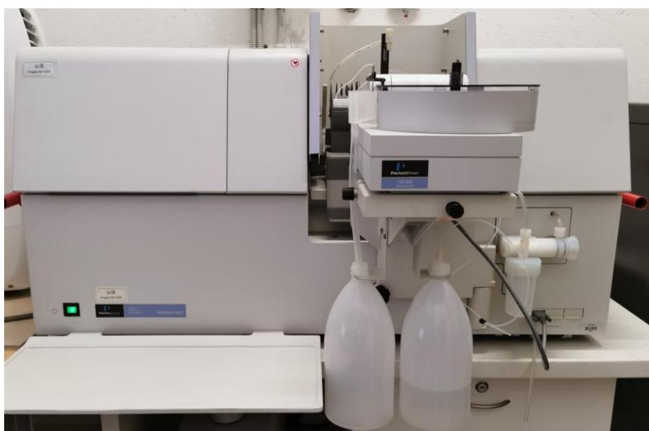
**Slika 32.** Atomski apsorpcijski spektrometar
